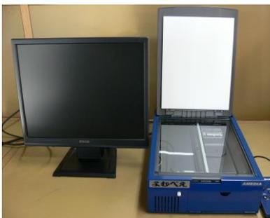
○音声拡大読書器「よむべえ」 印刷物を読み取り、読み取ったものを画面で表示しつつ、音声で読み上げる機器です。読み上げる速さや文字の大きさは、変更することができます。デージー録音図書を聞くこともできます。参考資料室でご利用いただけます。
